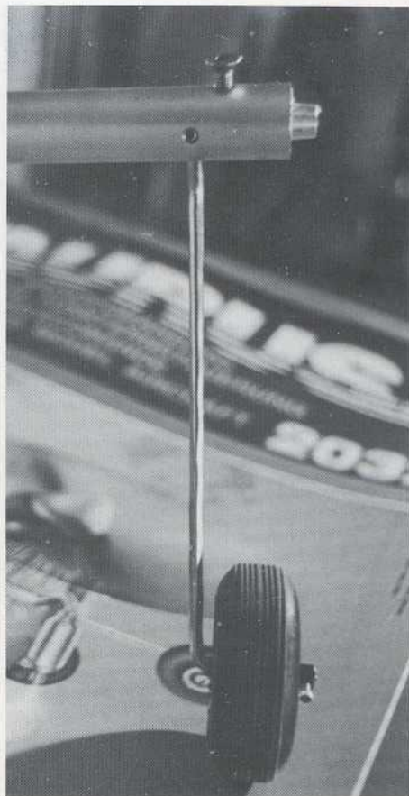
Les jambes du train principal sont astucieusement fixées sur la clef d'aile ; un ergot soudé empêche la corde à piano de pivoter.
