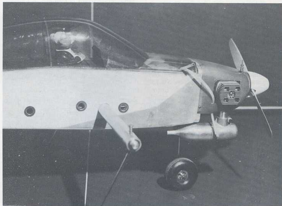
Gros plan sur le nez du modèle ; le silencieux Super Tigre, coulissant, est ici bien utile.
