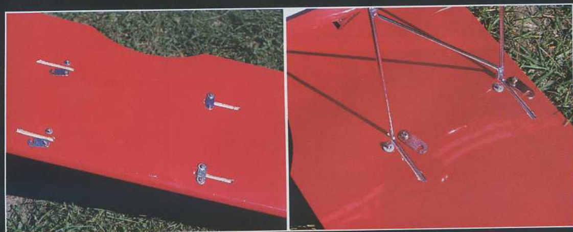
Petite astuce pour faciliter le montage des ailes supérieures : il suffit d'ouvrir l'un des trous de chaque cavalier et de le faire pivoter au montage, ce qui dispense de retirer les vis (au risque de les perdre).
