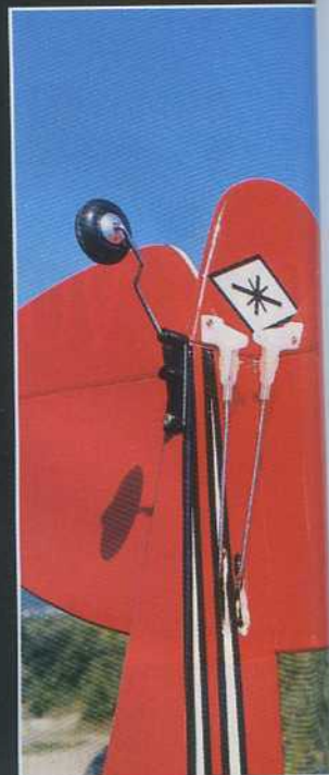
Le montage des commandes de profondeur et direction est aussi propre que classique, tout le matériel fourni dans le kit ayant été utilisé sans souci. Les chapes en plastique sont, comme toujours, à sécuriser par un petit tronçon de durite silicone.
