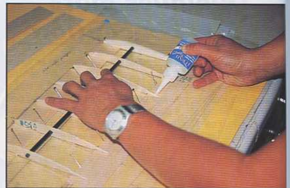
5) Collage des nervures à la cyano, sauf celle d'emplanture (N1) qui sera collée inclinée par la suite.
