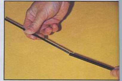
3) Les longerons sont constitués de tubes carbone de diamètre 4 et 6 emboîtés l'un dans l'autre puis collés (à plat pour l'aile trois axes et avec du dièdre pour l'aile 2 axes).
