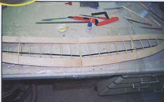
10) Les panneaux intérieurs sont alors collés contre ceux extérieurs en respectant le dièdre.
