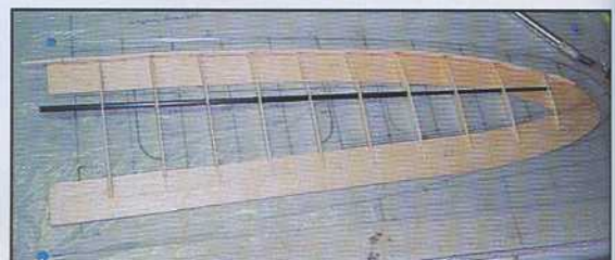
11) La demi-aile 3 axes est réalisée en une pièce (les tubes formant le longeron sont collés l'un dans l'autre, sans dièdre). Il reste à placer une cale de 20 mm sous le saumon pour coller la nervure d'emplanture.
