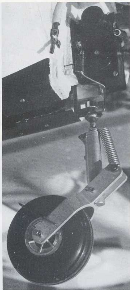
Le train avant du Marchetti. Il est monté verticalement sur la cloison avant. On distingue le levier de commande en c.a.p.
