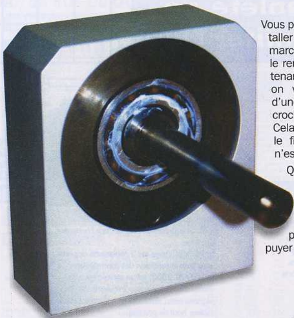
Le support moteur, côté pile.
