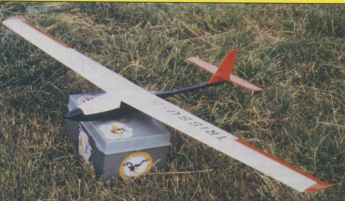
Le Trissu 05 ; fuselage bois, aile de 140, profil Raf 28, 600 g, deux voies.
