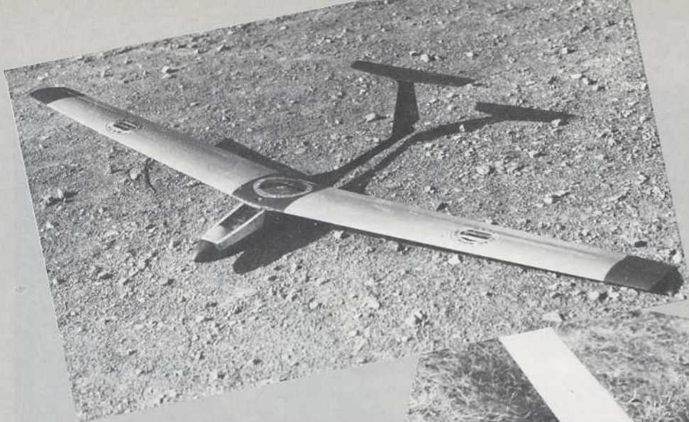
Le Trissu 04 : empennage en T é , grand allongement, Eppler 193 ; polyvalent plaine/pente : 1 er en Vdp à Champlitte (25/09/83), 3 e en plaine à Montbéliard (22/05/84).
