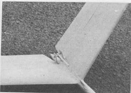
Le stabilo en vé est équipé de volets qui jouent uniquement le rôle de profondeur.
