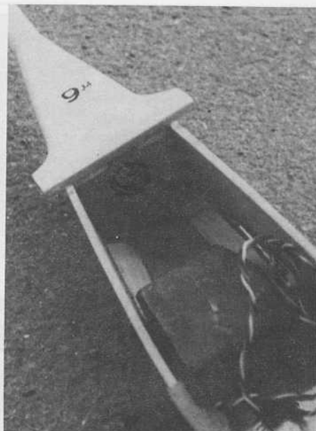
L'intérieur du fuselage : on aperçoit l'interrupteur, l'équerre en alu. et la vis traversant le capot qui maintiennent l'aile.
