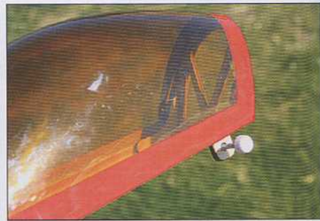
La grande verrière est solidement fixée par deux fêtons, deux aimants et deux vis.
