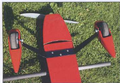
Le train bicycle en alu peint en noir est facilement vissé sous le fuselage.
