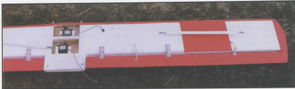
Vue de l'intrados de l'aile, avec servos et articulations des volets et des ailerons, et les mâts démontés.
