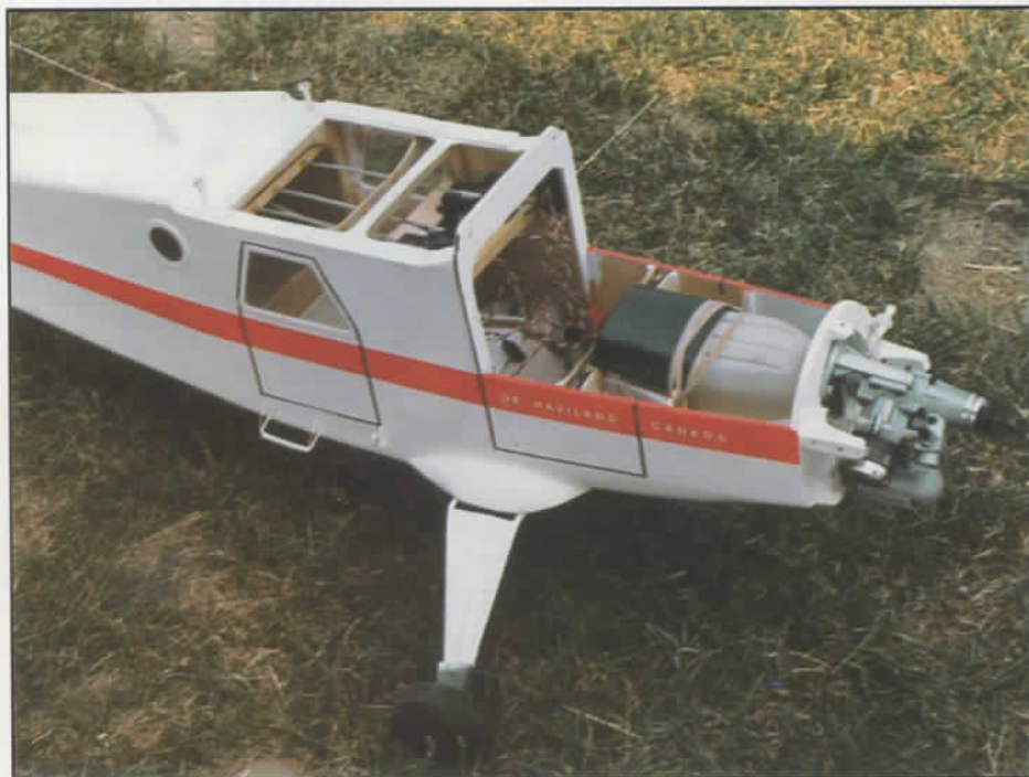
Autre vue, capots et aile démontés ; on note que la construction est soignée ; les accès sont très dégagés.
