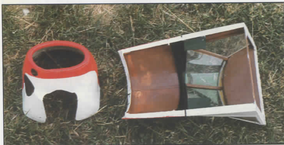
Détails du capot en papier kraft moulé, et de la verrière démontable.
