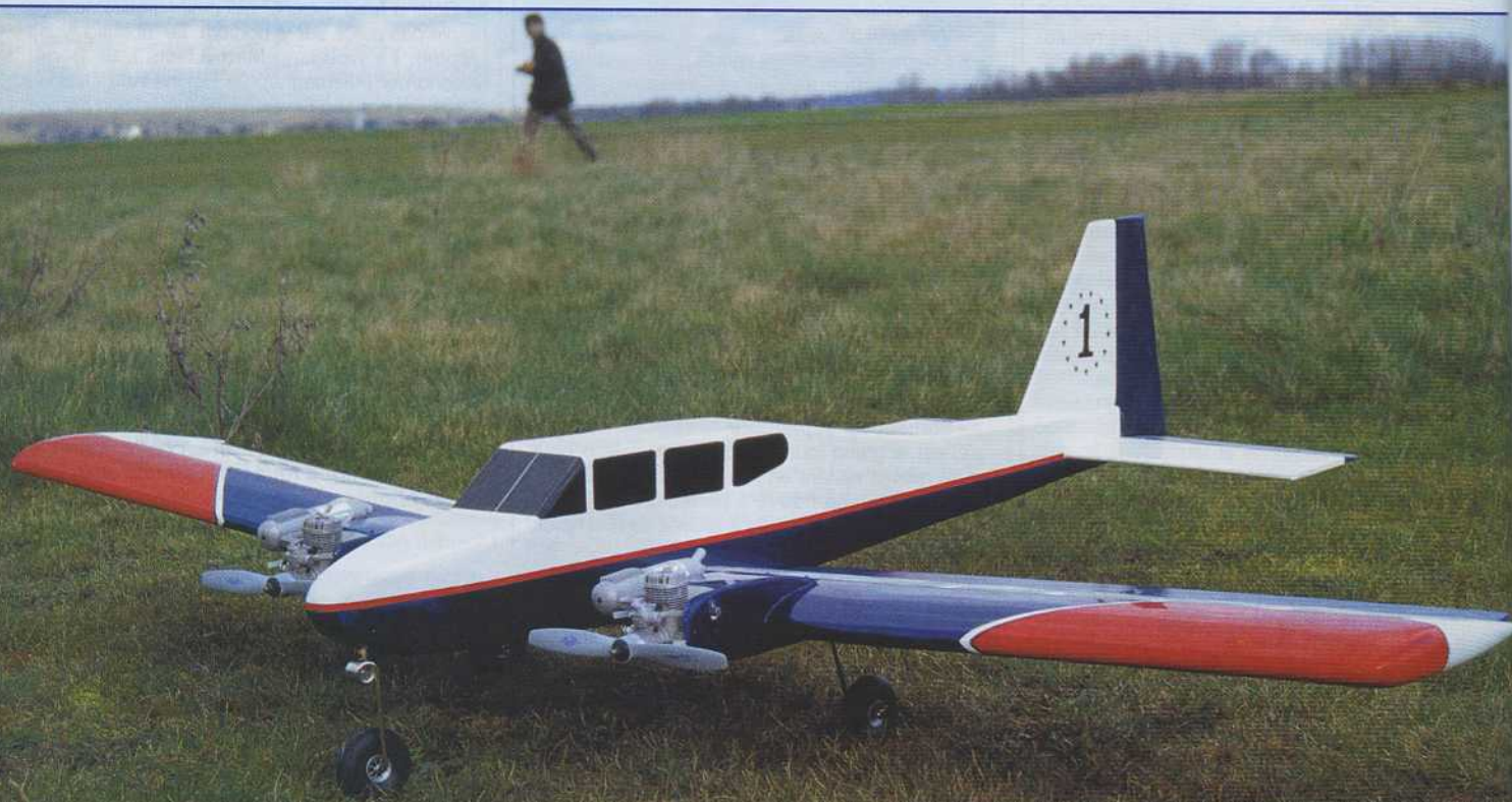
"LA" solution de ce bimoteur, pour supprimer le délicat problème des bimoteurs en vol lorsqu'un moteur tombe en carafe, consiste à rapprocher les moteurs le plus possible de l'axe du fuselage. Pari réussi sur ce Twin Easy le bien nommé !
