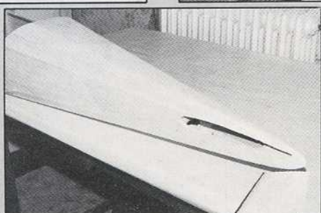
Photo 1 : pincement des flancs avec des serre-joints. Photo 2 : Les clés d'aile sont en place.
