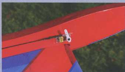
Les servos dépassent de chaque côté du fuselage. Les tringleries sont en joncs carbone, elles reçoivent à chaque extrémité des embouts en corde à piano pliés en « Z » qui sont collés et gainés.
