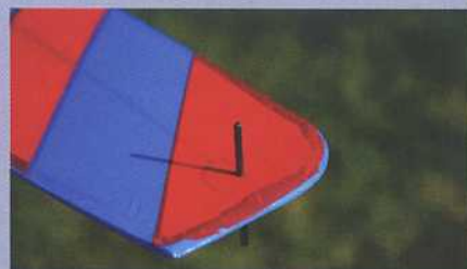
Le Peg est collé, il sera à installer le plus proche possible du longeron en carbone que l'on devine sous l'entoilage.
