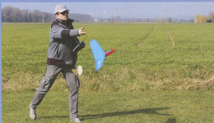
Au lancé, seule une rotation de 180° permet de propulser le Vick DLG à une altitude de 15 mètres environ, pour un vol de 30 à 40 secondes si l'on ne trouve pas de bulle...
