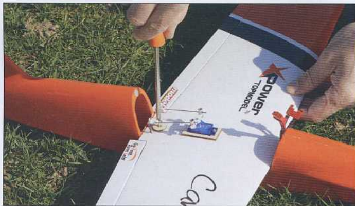
Le servo de profondeur est fixé dans le fuselage sur sa platine collée d'origine. Le récepteur est immobilisé au Velcro au fond du fuselage, juste devant.
