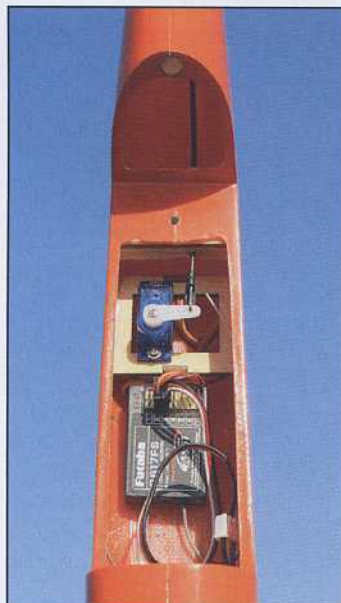
Le servo de profondeur est fixé dans le fuselage sur sa platine collée d'origine. Le récepteur est immobilisé au Velcro au fond du fuselage, juste devant.
