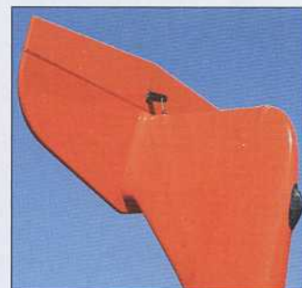
Le stabilisateur est vissé au sommet de la dérive (dépourvue de volet). Une corde à piano commande le volet de profondeur.
