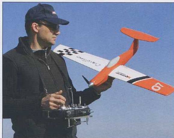
Un fuselage en fibre de verre, deux ailes en polystyrène coffré à assembler, un stabilisateur de type planche, et l'accastillage nécessaire au montage composent le kit signé Topmodel.
