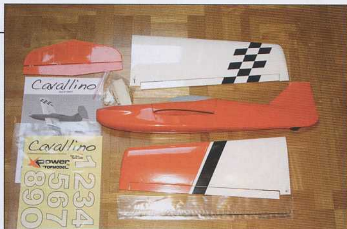
Un fuselage en fibre de verre, deux ailes en polystyrène coffré à assembler, un stabilisateur de type planche, et l'accastillage nécessaire au montage composent le kit signé Topmodel.
