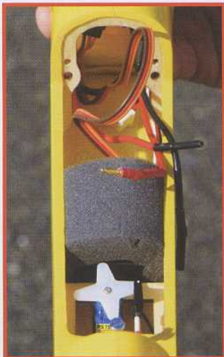
Le servo d'aileron et ses commande sont à l'aise sous la bulle... Une bonne solution pour ne pas interférer physiquement avec le reste de l'équipement.
