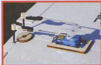
Le servo d'aileron et ses commande sont à l'aise sous la bulle... Une bonne solution pour ne pas interférer physiquement avec le reste de l'équipement.
