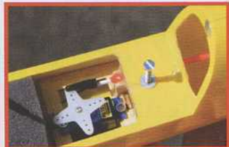
Le servo d'aileron et ses commande sont à l'aise sous la bulle... Une bonne solution pour ne pas interférer physiquement avec le reste de l'équipement.
