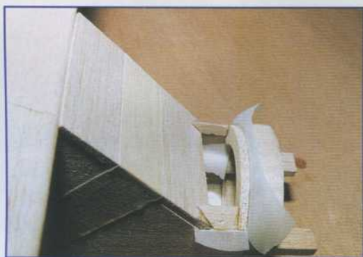
Pour former le capot avant amovible, on protège le fuselage avec de l'adhésif pour ne pas tout coller en place.
