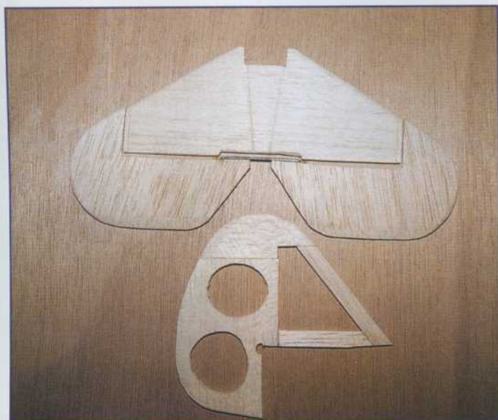
Les empennages, de section planche, sont en balsa léger.
