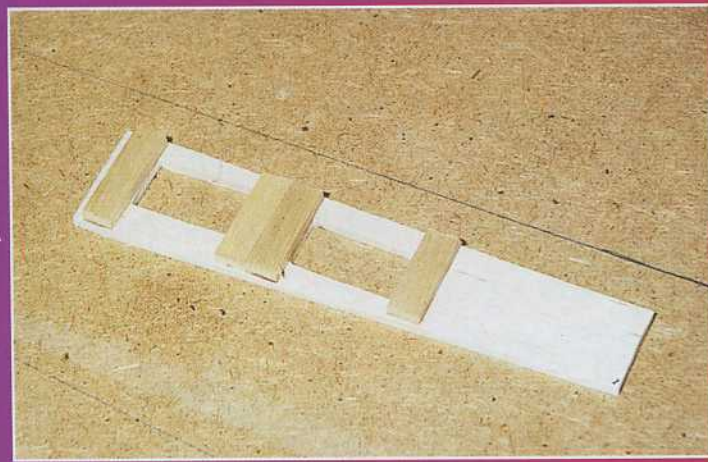
5 - Préparez la platine radio en balsa de 4 mm renforcée de baguettes bois dur 10 x 5.
