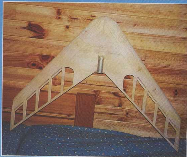
Ci-dessus : la structure de l'engin avant entoilage. Très classique, finalement, et sans difficulté particulière. A gauche : le "Zwazo" est très rapide à monter. C'est un avantage essentiel pour le GFC... N'est-ce-pas, Laurent ?
