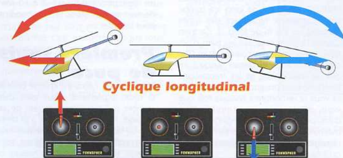
Cyclique longitudinal vers l'avant, l'hélico s'incline vers l'avant et translate vers l'avant.
