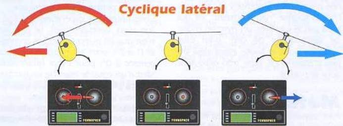
Cyclique latéral vers la gauche, inclinaison à gauche et translation vers la gauche
