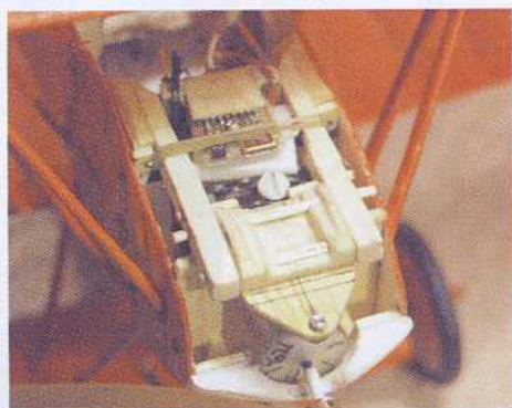
Montage moteur : on remarque bien le dispositif d'ajustement de l'anti-couple.
